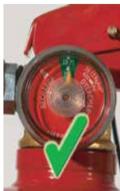
รูปที่ 1 เข็มอยู่ในช่องพื้นที่ "สีเขียว" แสดงว่า "เครื่องดับเพลิงอยู่ในสภาวะปกติ" พร้อมใช้งาน
